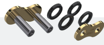
MRS : Maillons avec axes aux extrémités creuses, le rivetage s'effectue par refoulement de matière. (Outil : EASYRIV5)
